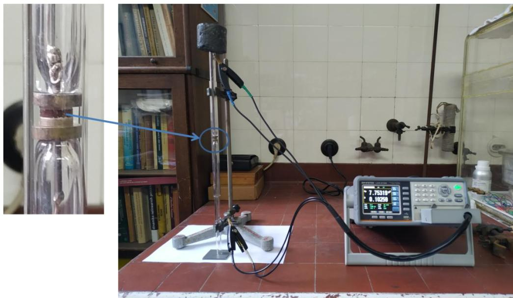
Slika 3.20. Sistem za merenje provodljivosti uzoraka
