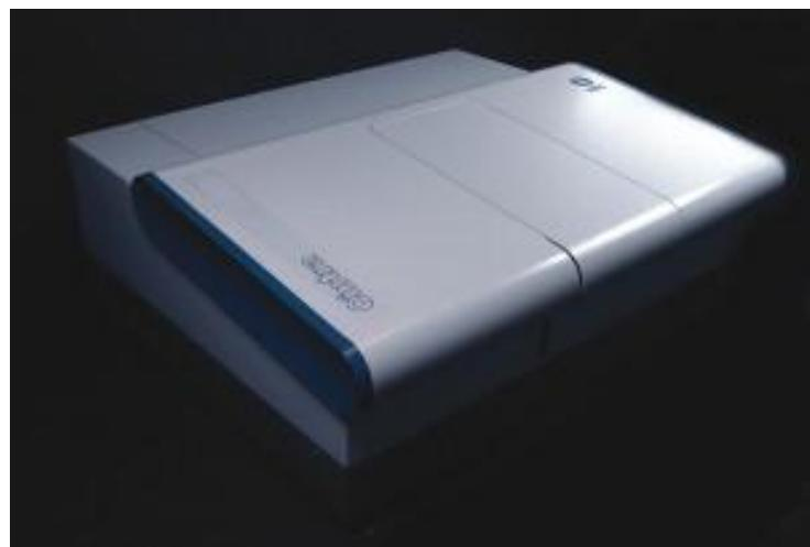
Slika 3.23. UV-Vis spektrofotometar GBC Cintra
