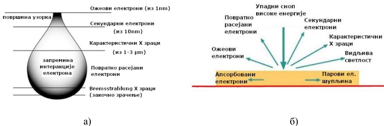
Слика 28. а) врсте електрона који се детектују код узорка и области из којих се добијају, б) врсте електрона који се детектују код танких узорка
