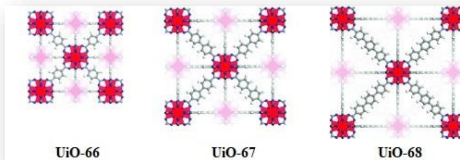
Slika 6. Zadržavanje simetrije MOF sa porastom dužine lanca organskog linkera. Linkeri su: tereftalatni dianjon u UiO-66, bifenil 4,4'-dikarboksilatni dianjon u UiO-67 i terfenil 4,4'-dikarboksilatni dianjon u UiO-68. Slika preuzeta sa dozvolom iz Journal of American Chemical Society , A new zirconium inorganic building brick forming metal organic frameworks with exceptional stability, autora J.H. Cavka et al, 130, 13850-13851. Copyright (2008) ACS [27].
