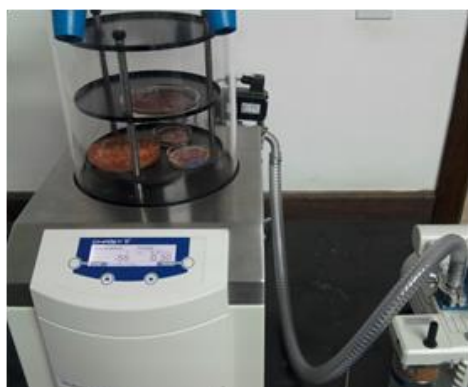
Slika 4.2.1.1 Šematski prikaz sinteze nanočestica Se u formi koloidnog rastvora. Donji deo slike prikazuje liofilizaciju dobijenog koloidnog rastvora i makroskopski izgled dobijenog praha.
