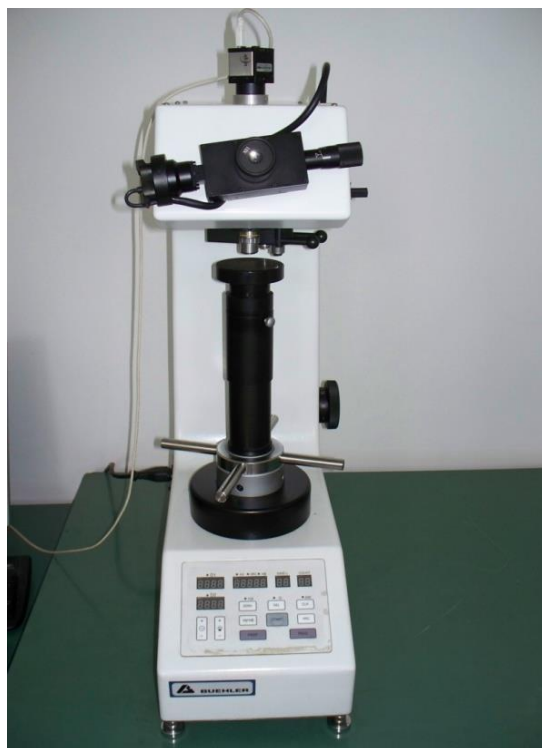
Slika 3.6. Uređaj za određivanje makro tvrdoće i žilavosti (Buehler Indentamet 1100 Series Semi-Macro & Macro Vickers Indentation Hardness Testers, USA)
