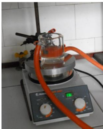
Слика 3.4. Изглед ћелије за фотокаталитичке експерименте.
