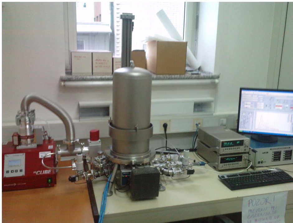
Slika 4.1. šZ-metreõ ure aj za merenje termoelektri nih svojstava u temperaturnom intervalu od 320 do 830 K.
